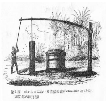
図2 ボルネオにおける直接製鉄 (Schwaner の 1843～1847 年の旅行記)
